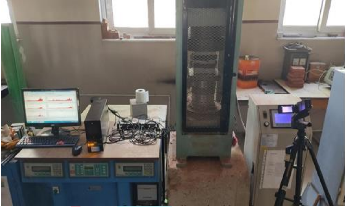
Şekil 3. Beton küp numune basınç deneyi düzeneği
