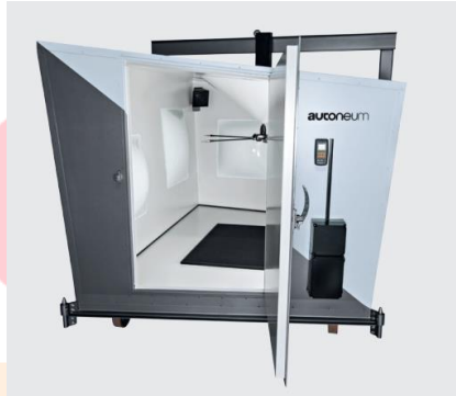
Şekil 13 Reverberation Test Kabini [14]
