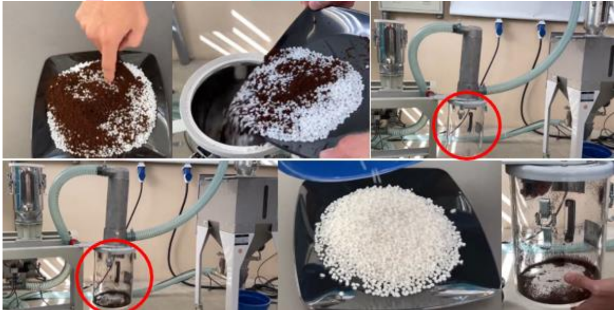
Şekil 7. Kahve-granül karışımının cihaz yardımıyla ayıklanması
