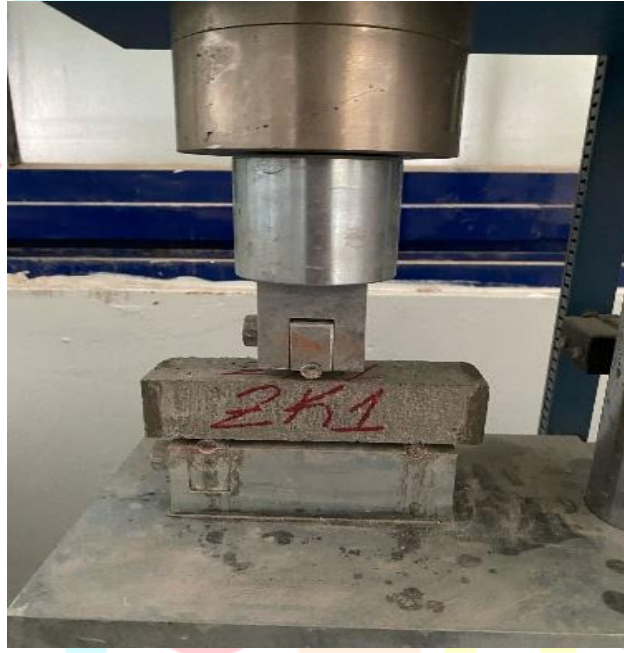
Şekil 1.1 3 noktalı eğilme dayanımı testi
