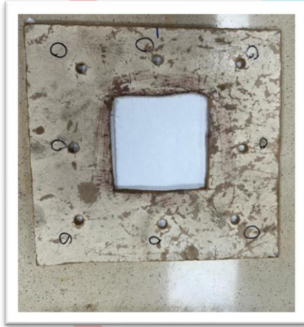
Şekil 1. SZC1 hava filtresi kâğıdının düzeneğe yerleştirilmesi
