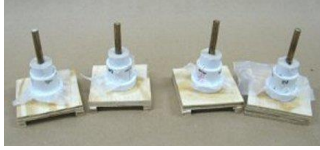
Görsel 19. Yakıt çekirdeklerinin dökümü (Richard Nakka, F70 PVC ROCKET MOTOR, 2017)(Casting of grain cores)
