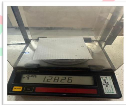
Şekil 7. Sartorius marka terazide ölçüm yapılan SZC1 hava filtresi kâğıdı
