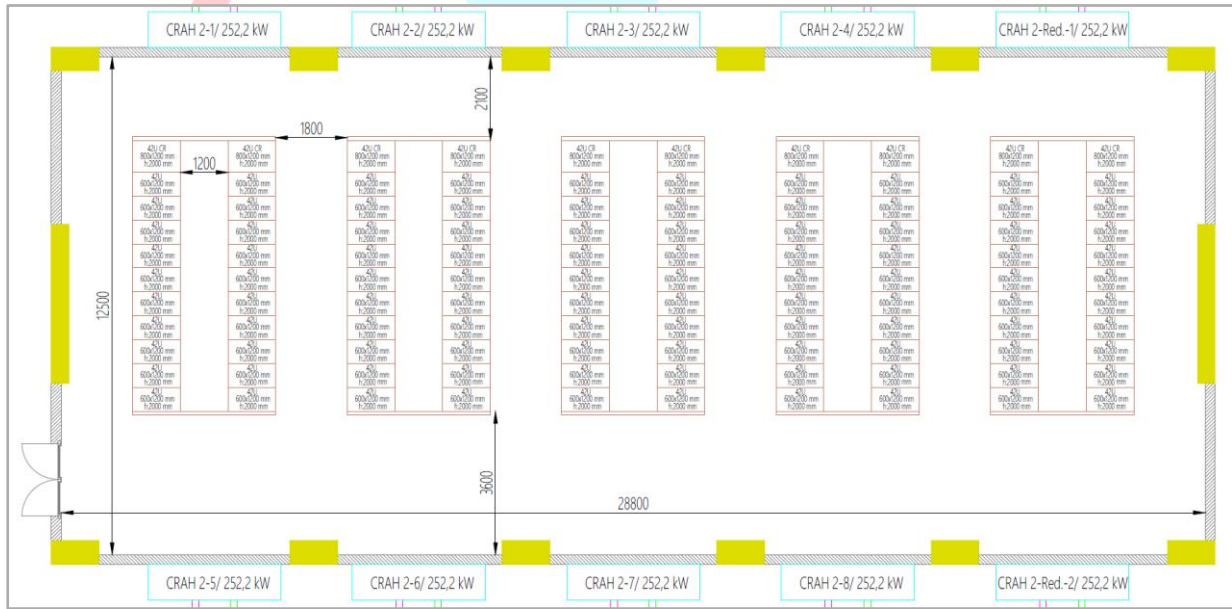
Şekil 3. Bir Veri Salonu ve CRAH Ünitelerinin Yerleşimi 5
