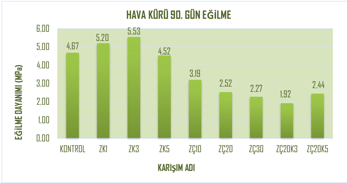
Şekil 2.6. Hava ile kürlenmiş karışımların 90.gün eğilme dayanımları
