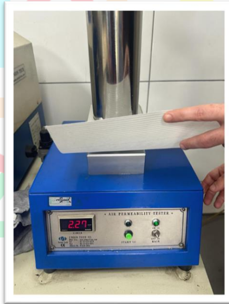
Şekil 4. SZC1 hava filtresi kâğıdının test cihazındaki görüntüsü
