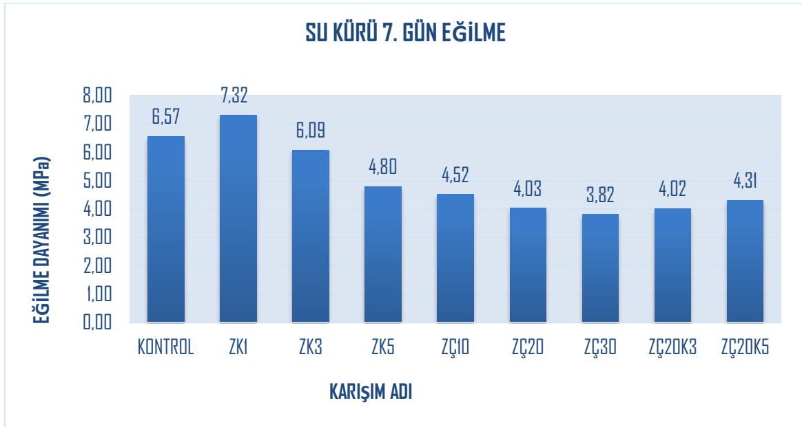
Şekil 2.10. Su ile kürlenmiş karışımların 7.gün eğilme dayanımları
