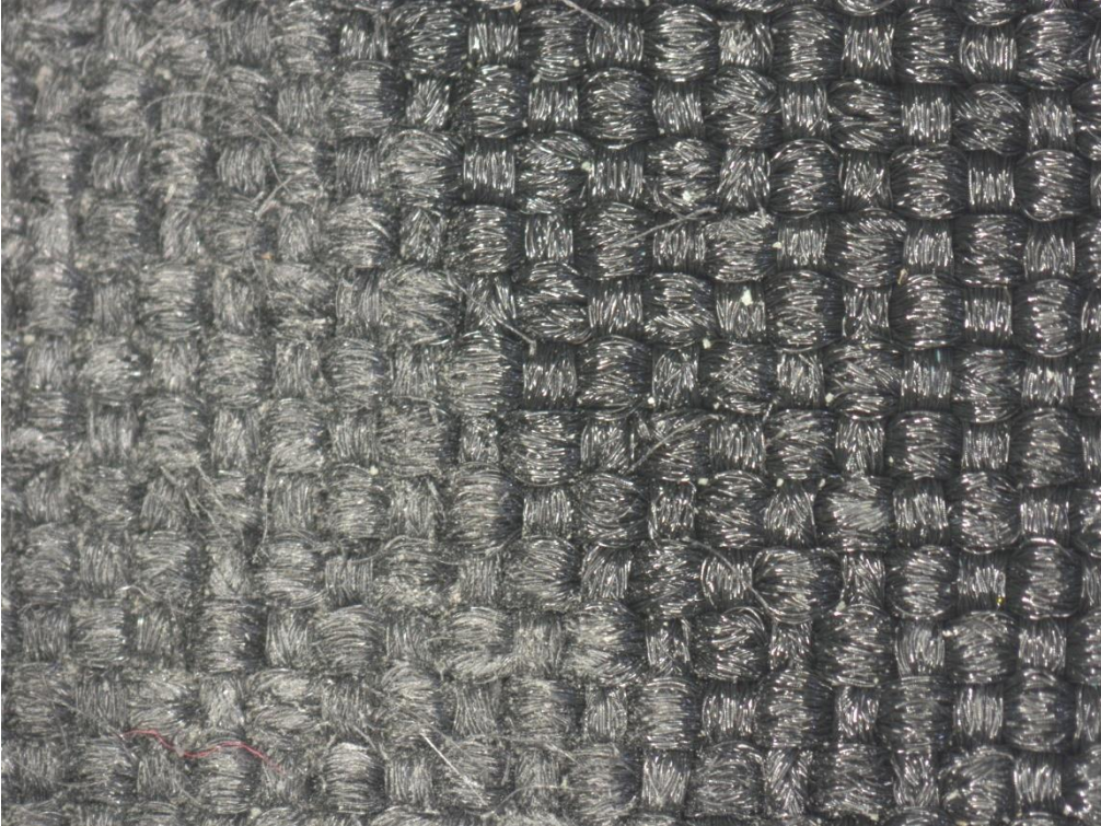
Görsel 2– Kumaş 1 Isıya Maruz Kalmış (sağ) Taber Sonrası (sol)
