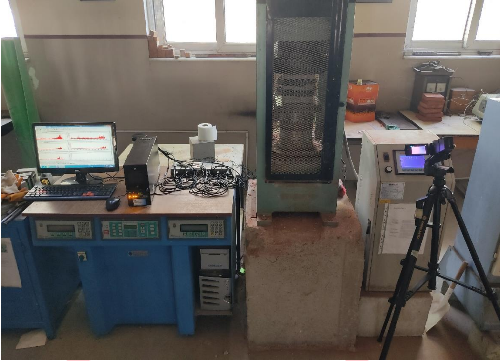
Şekil 3. Beton küp numune basınç deneyi ve AE kayıt düzeneği
